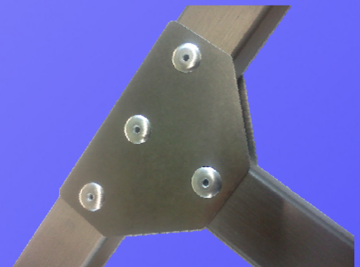
Eine Nietverbindung (da nicht geschweißt werden durfte)
